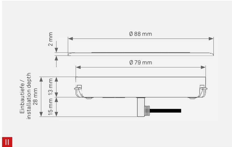
Einbauanleitung: sichtbarer Einbau | Installation instructions: visible installation
